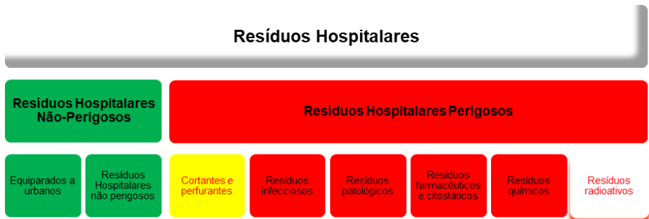
Figura 4: Esquema de segregação recomendado pela OMS, mas de acordo com as cores de materiais existentes na Guiné-Bissau
